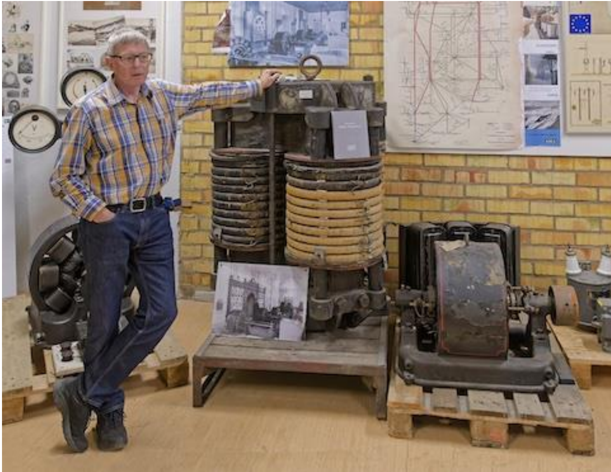
3-fastransformator vid linjen Hallsjön-Grängesberg 1883
